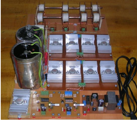
Şekil 8. Gerçekleştirilen elektromanyetik fırlatıcı devresi
